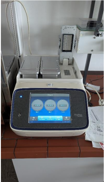
PCR Maschine: Vervielfältigung der Mikrosatelliten DNA
